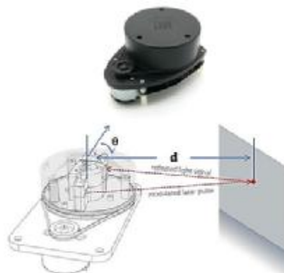
شکل ۲- الف) اساس کار حسگر لیزری RPLIDAR و ب) محل نصب آن در جلوی تراکتور
