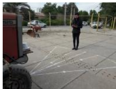
شکل ۶- آزمون ارزیابی عملکرد حسگر لیزری در تشخیص موانع در حالت توقف تراکتور
